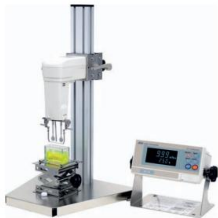
Вискозиметры серий SV и SV-A
